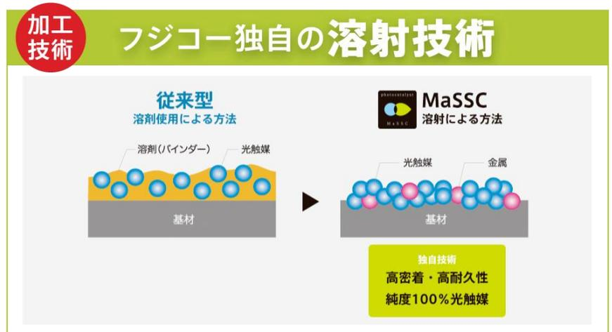
従来の光触媒は、光触媒を溶剤と呼ばれる液体に混ぜてコーティングしていました。それにより、光触媒が溶剤に埋もれてしまい、触媒反応する量が少なくなっていました。そこでフジコーが得意とする「溶射」技術を使うことで、基材の表面を高密度で 100%近い光触媒で被うことができ、格段に光触媒反応がアップしました。
